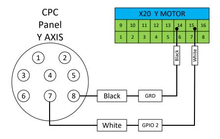
7661-3 CONVERTS A 7661-2 AND ADDS A BRAKE CONNECTION FOR THE Y AXIS.
